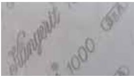
Kawat kelas atas yang diperkuat bahan untuk pemakaian ekstrim. Direkomendasikan untuk kondisi tekanan dan suhu yang berubah-ubah. Terbuat dari serat asbes chrysotile yang terikat dengan SBR dan diperkuat dengan menghubungkan serat kawat baja.
