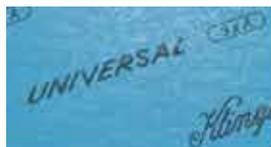
Bahan tahan minyak dengan kualitas terbaik terbuat dari serat asbes chrysotile bermutu dengan pengikat karet nitril butadiena (NBR). Terutama sesuai untuk digunakan pada industri penerbangan dan dengan minyak panas dan cairan termal.
